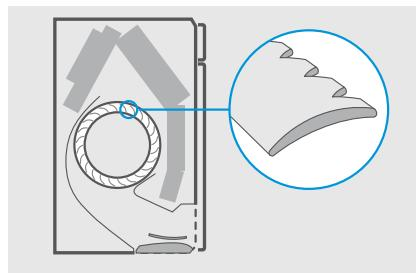
Pentru a atinge o eficiență energetică ridicată, Daikin a proiectat un ventilator nou, care funcționează eficient în cadrul dimensiunilor compacte ale unității Stylish. Împreună, ventilatorul și schimbătorul de căldură ating performanță energetică superioară, având însă un nivel de zgomot insesizibil de persoanele prezente în încăpere.
